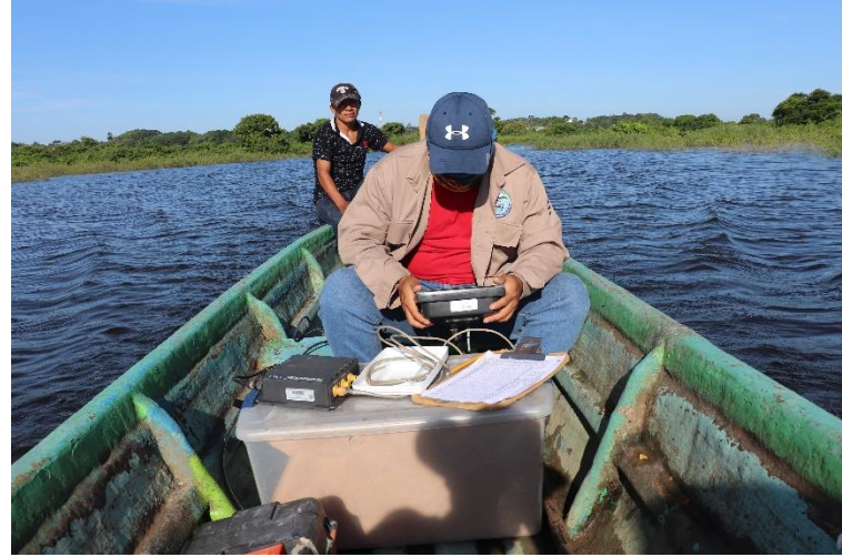
Figura 4. Monitoreo acuático con sonar de barrido lateral.
